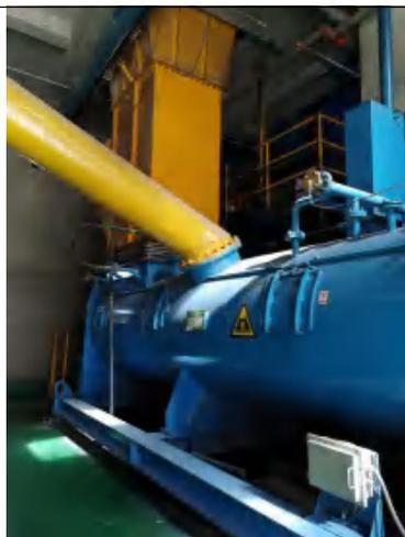
固态/半固态危废泵送装置
